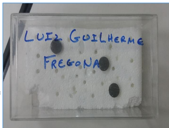
Figura 23 - Local de armazenamento dos stubs recobertos para análise em MEV. Caixa de acrílico (proteção e armazenagem) e isopor (estabilização) são os materiais padrões utilizados na etapa de estocagem.
