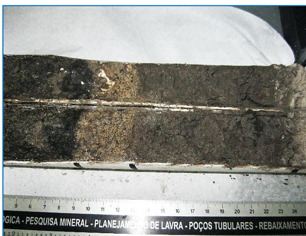
Figura 27 - Imagem da porção intermediária da amostra P3R. Observar a transição de estratos arenosos amarelados (em contato com argilas negras) para siltes areno-siltosos cinza – amarronzados na base.
