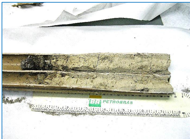
Figura 30 - Imagem da amostra P30. Presença de estruturas de retrabalhamento (clastos de argila negra nos sedimentos silto-arenosos acinzentados) no contato entre litologias.
