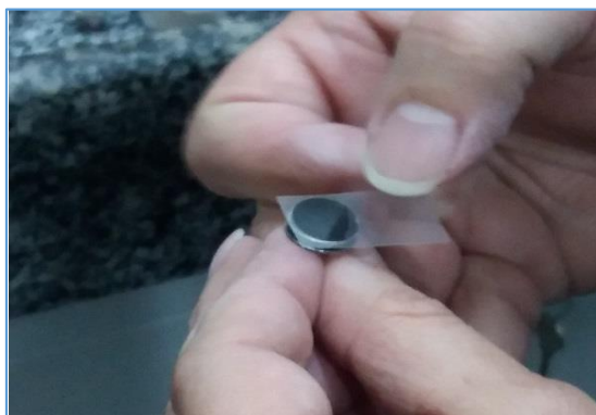
Figura 21 - Fita dupla face grafitosa sendo colocada na cabeça do stub .
