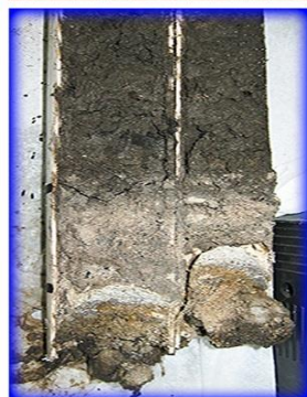
Figura A – À direita, testemunho amostrado à 70 m da costa no canal principal de tráfego de embarcações. Observar a gradação de camadas compostas por sedimentos grosseiros na base, para níveis de sedimentos mais finos no topo. À esquerda, imagens mais próximas das porções basais (em azul), intermediárias (em vermelho) e superiores (em verde).
