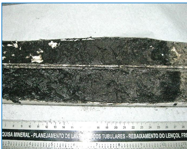
Figura 26 – Fotografia do topo da amostra P3R. Atentar a presença de camada argilosa rica em matéria orgânica característica da região. Neste testemunho, sua espessura foi de 40 cm.
