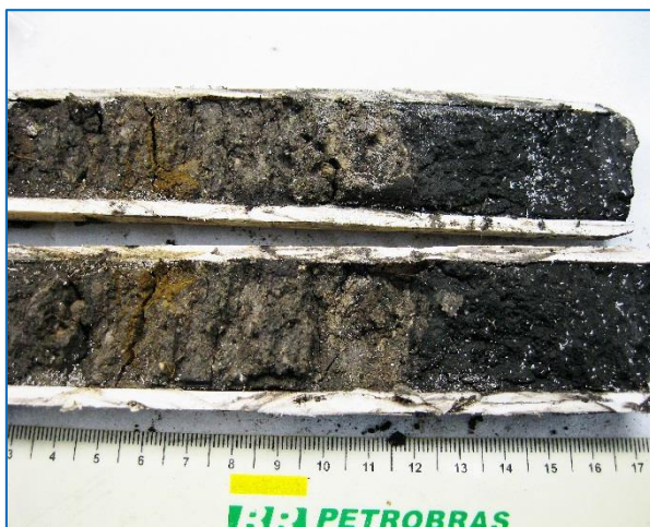
Figura 32 – Imagem do testemunho da amostra P2i. Notar a variação das características sedimentológicas entre os estratos argilosos. Camada superior amarronzada pobre em MO e com glomérulos de areia fina, camada basal negra rica em MO composta apenas de argila.
