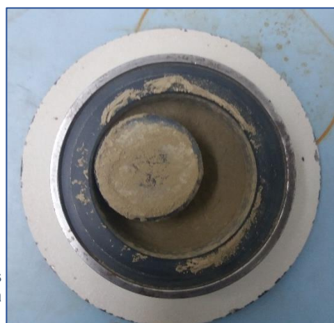
Figura 19 - Aparência final das amostras argilosas após processo de trituração. Observar o espalhamento da amostra por todo o interior do suporte
