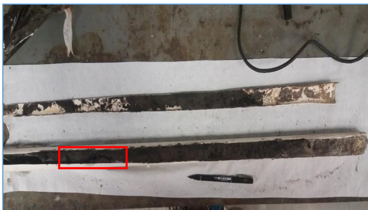
Figura 13 - Testemunho de sedimentos de fundo aberto, local de coleta assinalado em vermelho.
