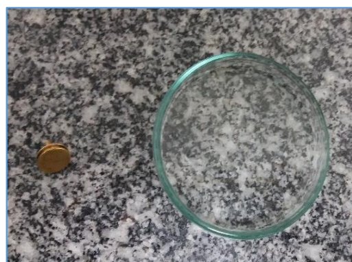
Figura 22 – À esquerda, stub de liga de alumínio e cobre. A direita, placa de petri. Ambos utilizados na etapa 3.
