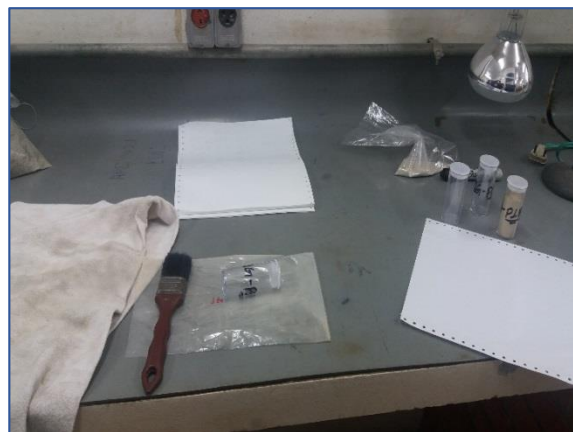
Figura 20 - Local de tratamento amostral pré-análises. Pincel, jato de ar comprimido, álcool, papel para quarteamento e tubos para alíquotas finais foram os equipamentos utilizados.
