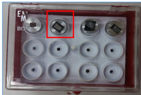
Figura 24 - Padrões e grades que podem ser usados na regulação pré análise em MEV. Atentar a padrão de cobalto destacado em vermelho.
