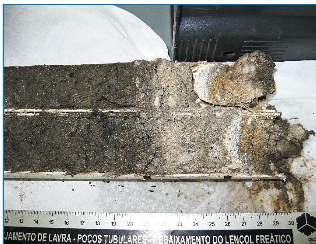
Figura 28 - Foto da base da amostra P3R. Presença de sedimentos mais grossos em relação as outras porções do testemunho. Notar a gradação de sedimentos arenosos grossos (porção cinza-esbranquiçada) para cascalheiras em direção a base do testemunho.
