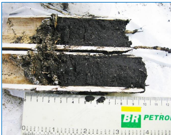
Figura 31 – Foto da amostra P1i. Argilas negras predominam em toda a sua extensão. Atentar à porção superior intensamente bioturbada pelas raízes.
