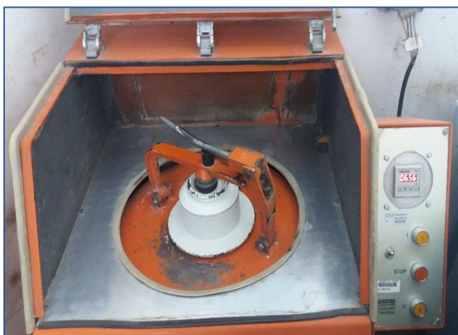
Figura 18 - Triturador mecânico. Notar suporte branco em formato de "chapéu" no centro do aparelho, local onde as amostras são confinadas e posteriormente desagregadas.
