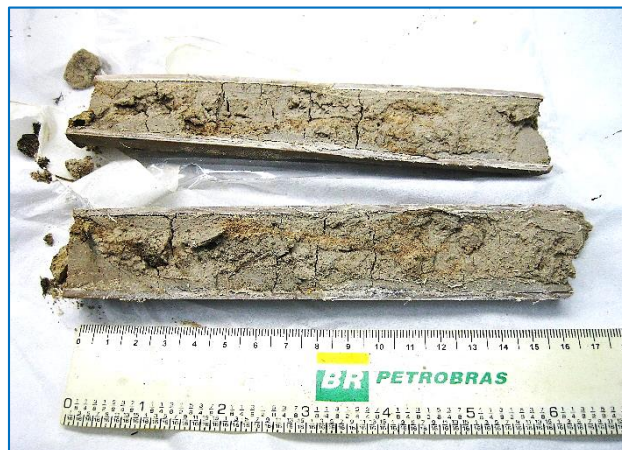
Figura 29 - Fotografia do testemunho P20. Notar fraturas em toda a extensão do sedimento, indicativo de litificação dos sedimentos. Base da amostra localiza-se à direita do testemunho.
